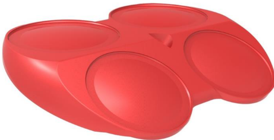
Obr. 38 Kompresní objem (pohled na ventily)
