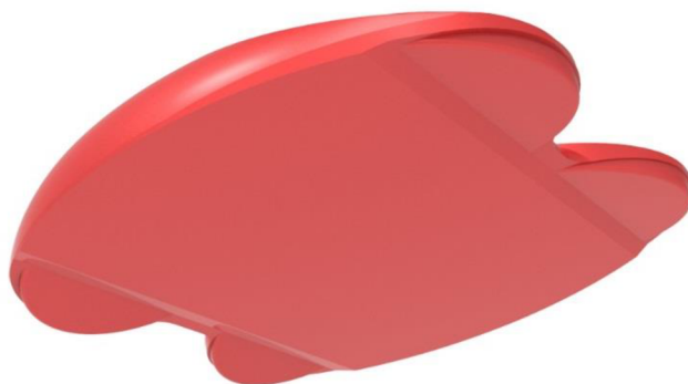
Obr. 39 Kompresní objem motoru (pohled od pístu)
