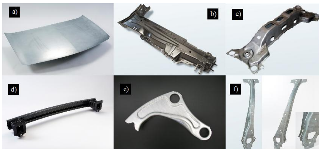
Obr. 2.3.6.2 Příklady aplikací ocelí v automobilu, a) kapota z oceli IF220, b) přední podélný nosník z oceli 300BH, c) zadní příčník potažený ocelí HSLA300 d) nárazník z oceli DP1180 e) vzpěra z oceli CP800 f) výztuž B-sloupku z oceli TRIP780 [6]
