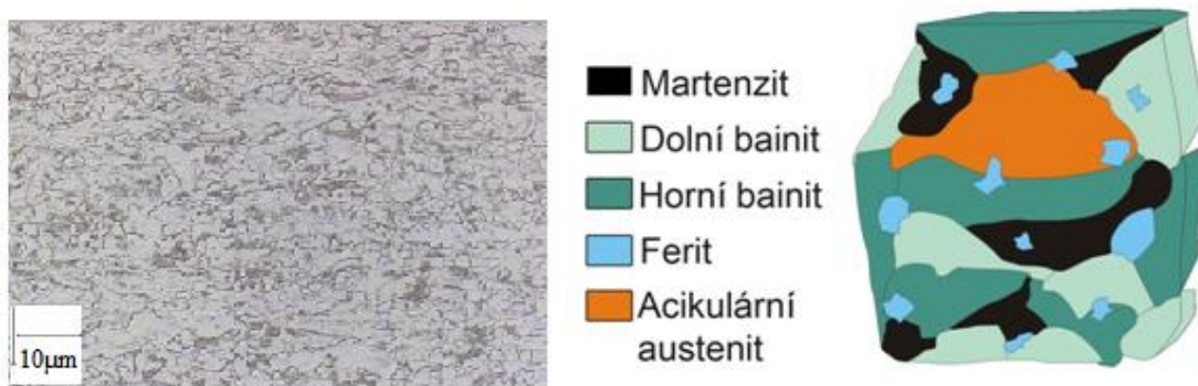
Obr. 2.3.2.1 Mikrostruktura oceli CP 800 [2,6]
