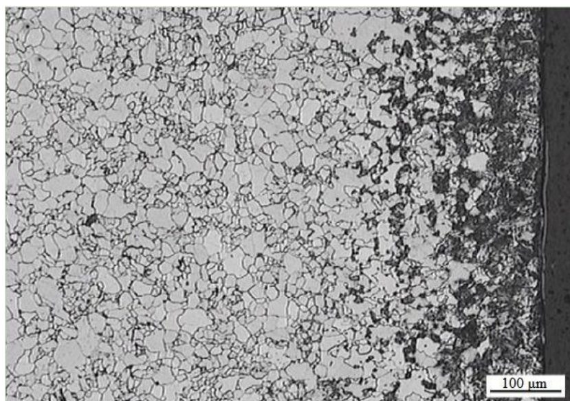
Obr. 2.5.1.1 Tepelně ovlivněná oblast feriticko - perlitické mikrostruktury [23]
