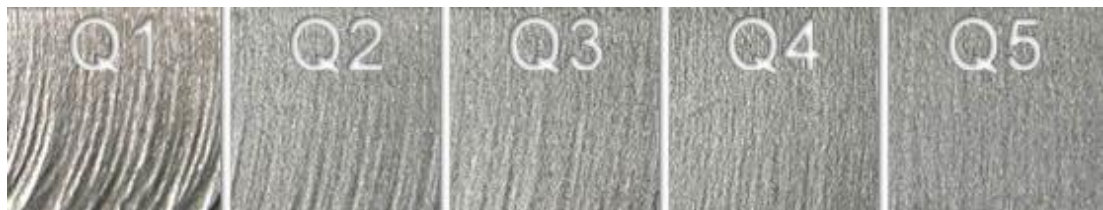
Obr. 2.5.2.2 Hodnocení kvality řezu vodním paprskem [25]
