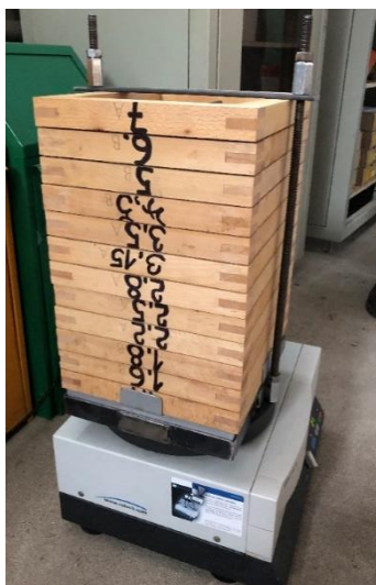
Obrázek 13 Upravená prosévačka RETSCH AS 200
