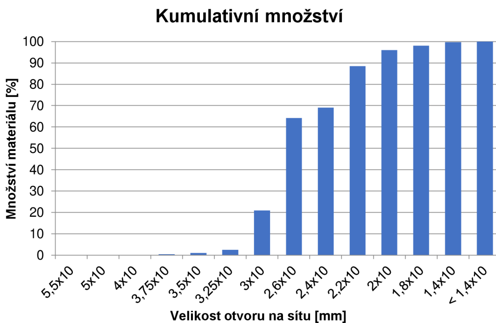
Obrázek 15 Kumulativní množství materiálu na sítích s obdélníkovými otvory
