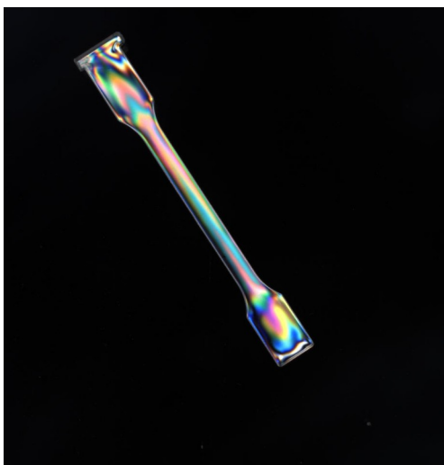
Obrázek 2.2: Trvalé napětí způsobené vstříkáním.
