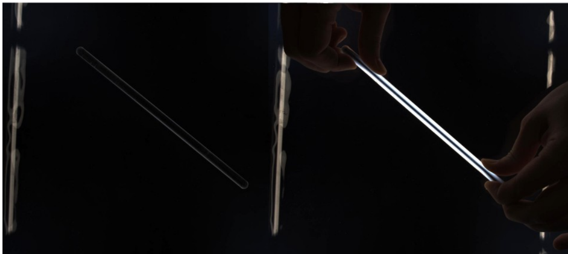
Obrázek 2.3: Přechodné napětí na zatížené skleněné tyčince
