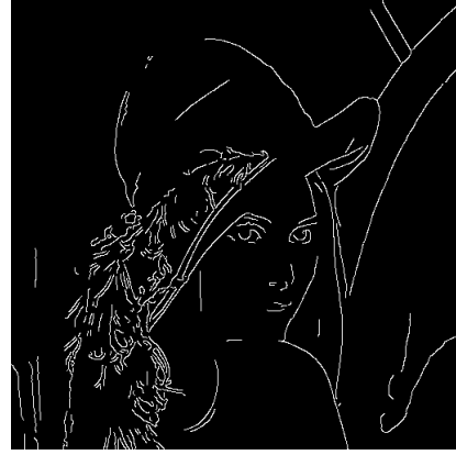
Obr. 1.7: Obraz po použití Canny detektoru hrán
