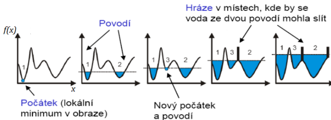
Obr. 6: Princip segmentace rozvodím [24]
