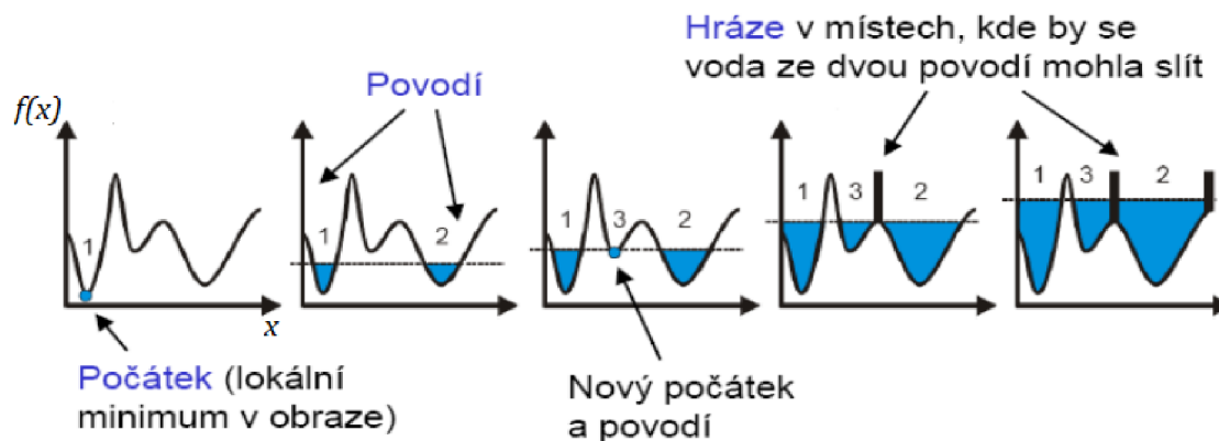
Obr. 6: Princip segmentace rozvodím [24]
