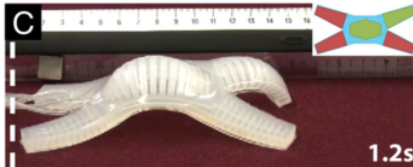
Obrázek 9: Multigait soft robot[10]
