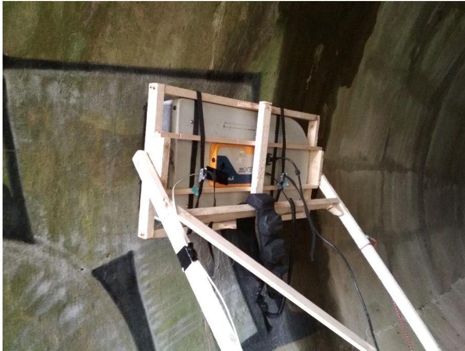
Obr. 38 – Měření metodou GPR na stěnách tunelu
