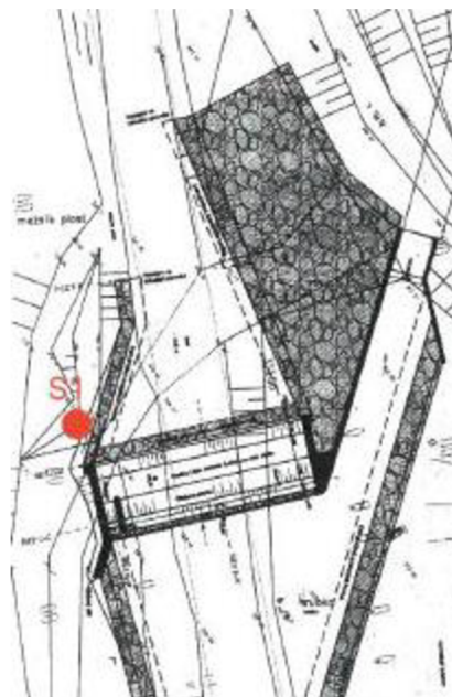
Obr. 3 – Schéma umístění Sondy S1 u jezu
