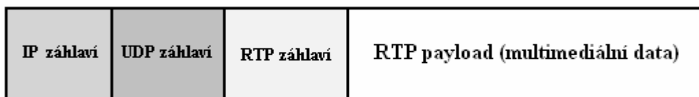
Obrázek 4.1: Datagram s paketem protokolu RTP
