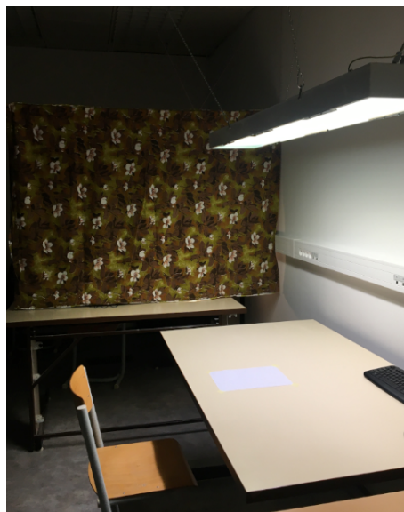
Obr. 3.7: Laboratoř FM TUL, osvětlený stůl 1 000 lx, stínící závěs (zdroj: autor)
