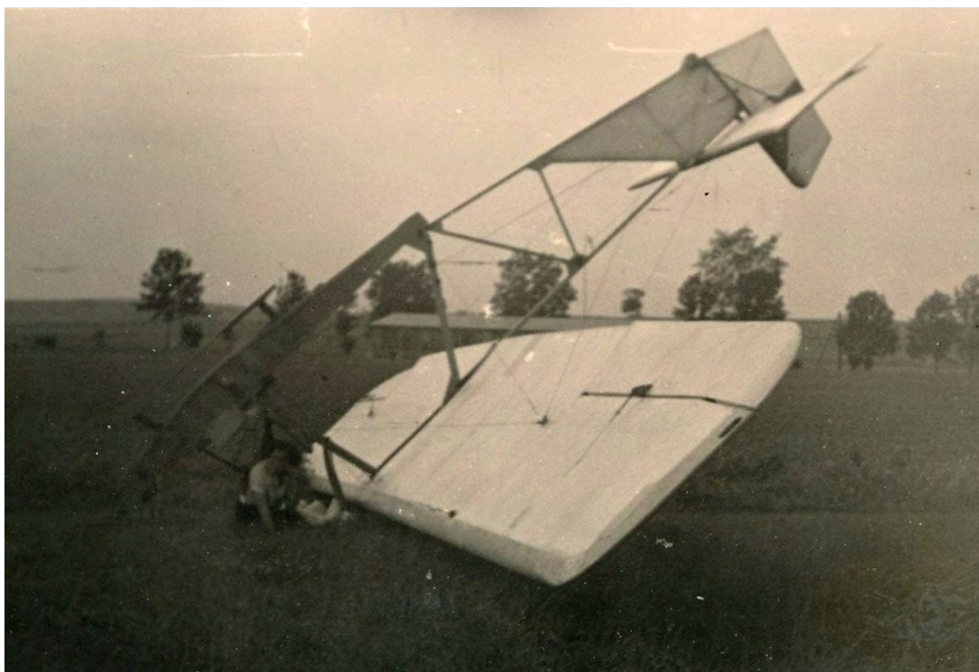
Havárie školního kluzáku SG-38 po „přistání“ bez podrovnání. Hlavní aktérka nehody, plachtařka Bulušková, sedí u letadla. Letiště Vrchlabí, sezóna 1948. Ze soukromého archivu pana Dušana Patočky, s jeho laskavým svolením.
