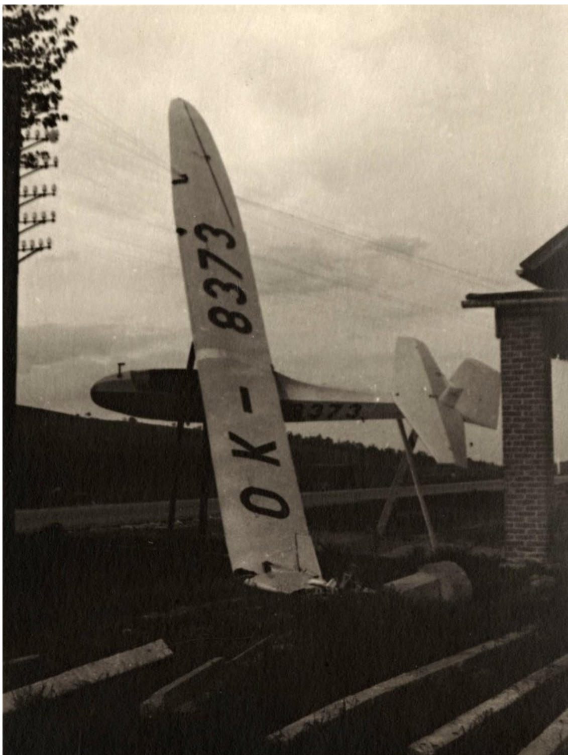
Nehoda vrchlabské Grunau-Baby IIb, OK-8373, která se naštěstí obešla bez zranění pilota. Povšimněte si elektrických drátů zaříznutých do náběžné hrany pravého křídla. Ze soukromé sbírky pana Martina Tůmy.
