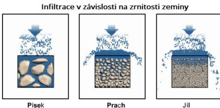
Obr. 2.2.1 - Infiltrace v zemině [portal.chmi.cz]
