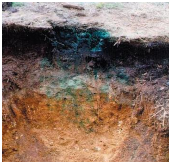
Obr. 3.2.1 – Vertikální řez po aplikaci barevného stopovače [Zumr 2008]
