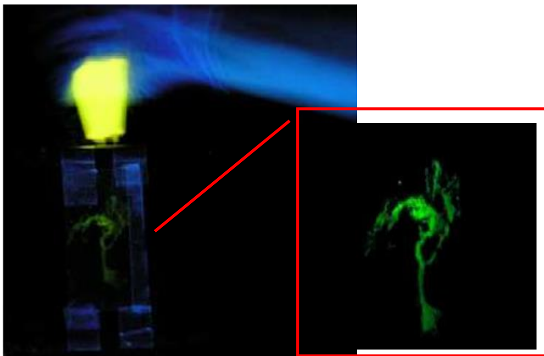
Obr. 3.2.2 – Experiment s fluorescenčním stopovačem Rhodamine 6G, vizualizace preferenční oblasti proudění [Zumr 2008]
