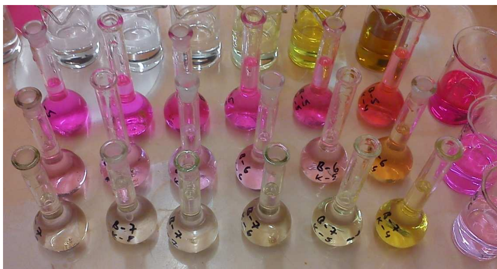
Obrázek 14: Příprava směsí nanočástic stříbra a Rhodaminu B různých koncentrací
