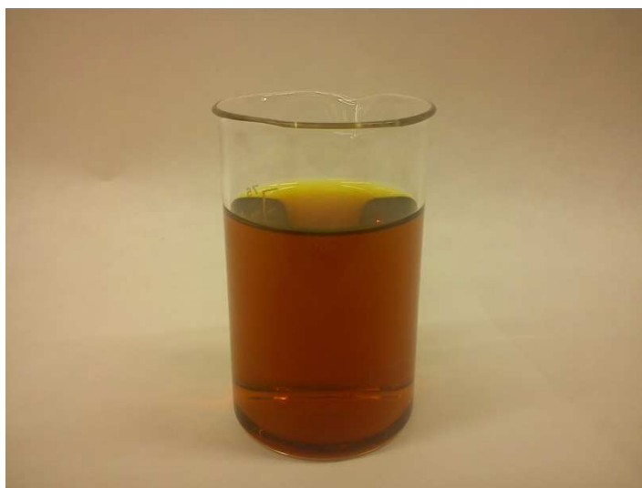
Obrázek 10: Vodná disperze nanočástic stříbra o velikosti 32 nm připravená modifikovanou Tollensovou metodou
