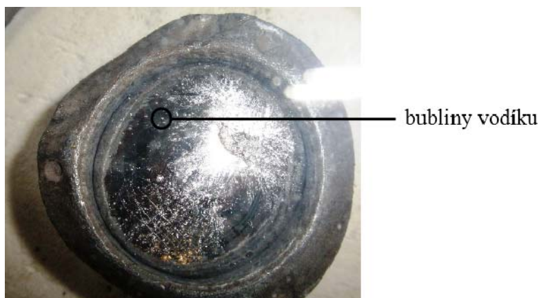
Obr. 2-8 Vyplování bublin H_2 při tuhnutí vzorku za podtlaku u metody dvojího vážení
