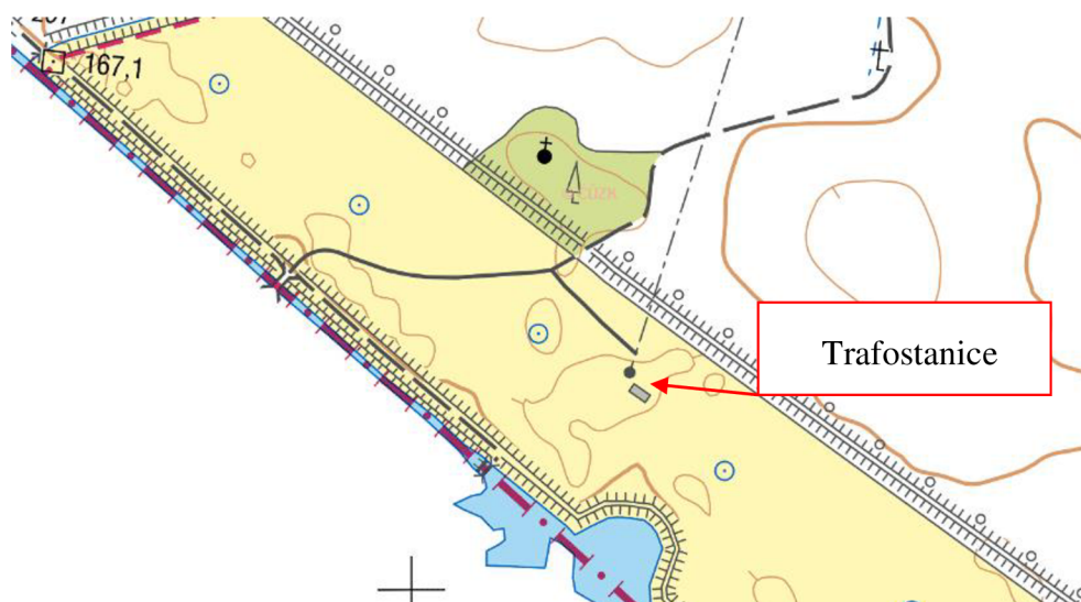
Obrázek 18 – Napojení na stávající trafostanici
