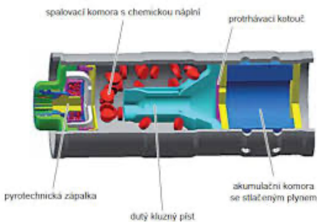
Obrázek 17 Hybridní plynový generátor
