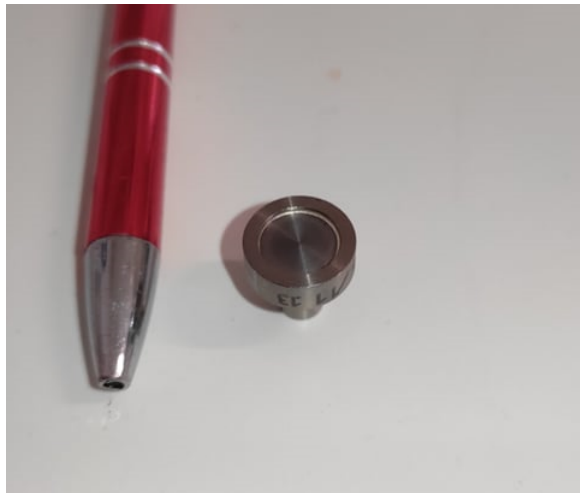
Obrázek 15: Zářič ^{57}\text{Co} v rhodiové matici (vlevo propiska pro srovnání velikosti).
