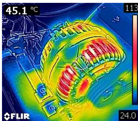
Obr.59 Termosnímek alternátoru zatíženého jmenovitým proudem 120 A
