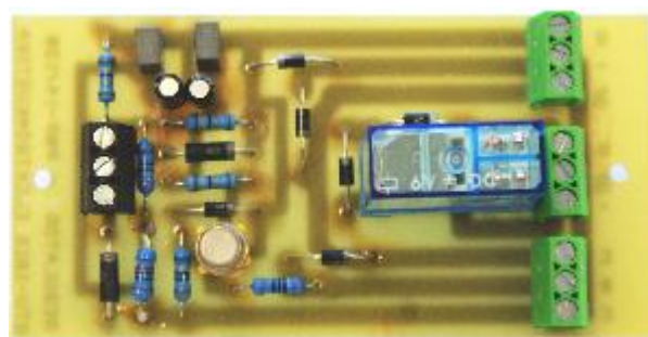
Obr.110 Upravená deska plošných spojů lineárního regulátoru
