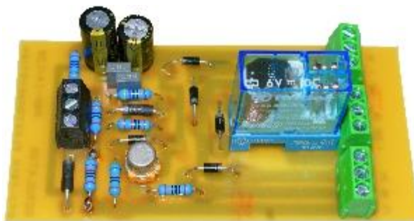
Obr.107 Osazená deska plošných spojů ověřovacího lineárního regulátoru
