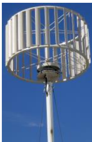
Obr.2 Oběžné kolo turbíny VAWT Seahawk s pomaloběžným diskovým generátorem [1]
