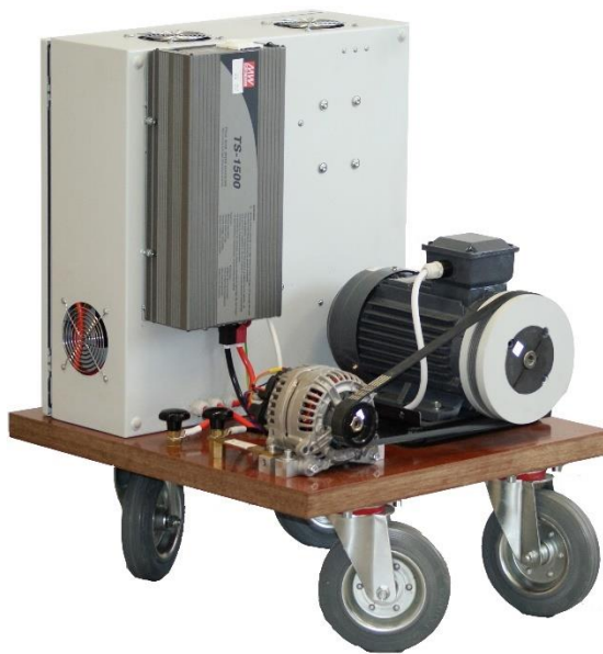
Obr.83 Střídač MW TS-1500-212B nainstalovaný na rozvaděči soustrojí
