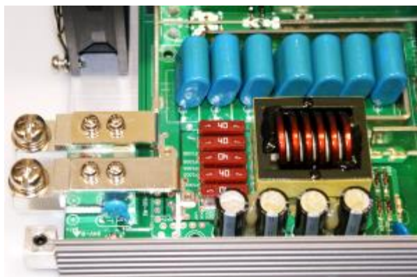
Obr.87 Vstupní filtr na střídače MW TS-1500-212B
