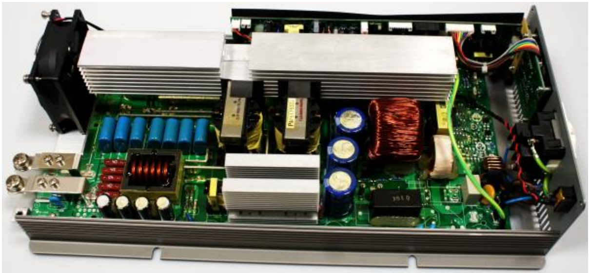
Obr.24 Vnitřní uspořádání střídače MeanWell TS-1500
