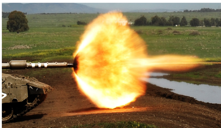
Obrázek 2.7: Záblesk při výstřelu z tankového kanonu ráže 120mm, převzato a upraveno 4
