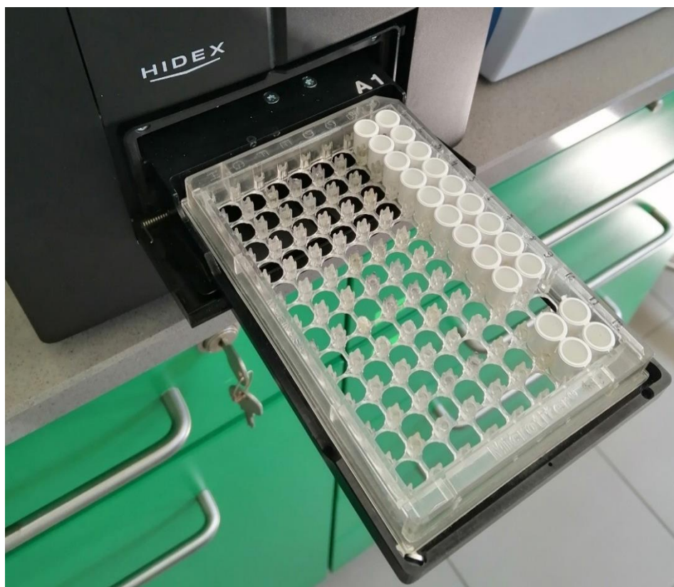
Obrázok 43: Pracovná doštička (Microtiter) s umiestnenými mištičkami, uložená na automatiky výsuvnej podložke z Luminometru (Multimodal Micropalte Reader, HIDEX Senese)
