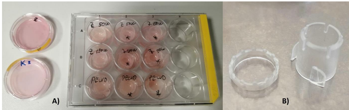
Obrázok 42: A) Kultúra buniek A375 vysiatá na korunky s uchytenými nanovláknami, umiestnená do plastových kultivačných misiek. B) Dvojdielna korunka (CellCrown™, Insets, Sigma Aldrich), väčší masívny diel sa umiestňoval výrezmi na modifikovanú stranu nanovláknien a menší krúžkový diel sa nasádzal z druhej strany, tak aby napevno uchytil nanovlákná.
