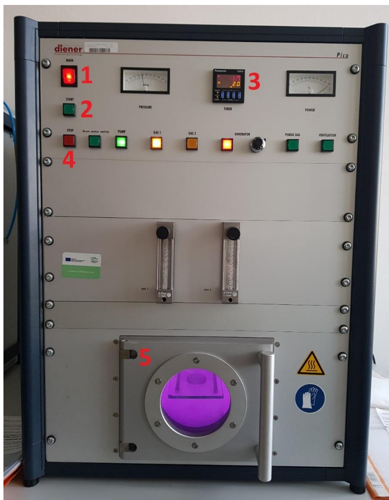
Obrázok 31: Plazmový reaktor Femto (Deiner), 1-Hlavný vypínač, 2-Štart, 3-Časovač, 4-Stop, 5-vstup do reaktoru
