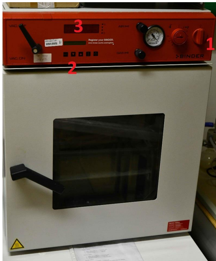
Obrázok 36: Pec (Binder), 1-Štart/stop, 2-Nastavenie, 3-displej
