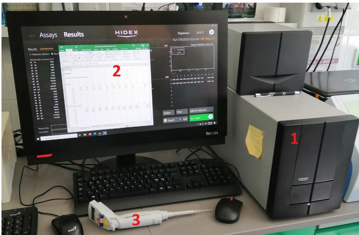
Obrázok 40: Zostava pre príliferčný test, 1-Luminometer (Multimodal Microplate Reader, HIDE X Senese), 2-riadiaci PC s programom (HIDE X), 3-Automatizovaná digitálna pipeta (Research pro, Eppendorf)
