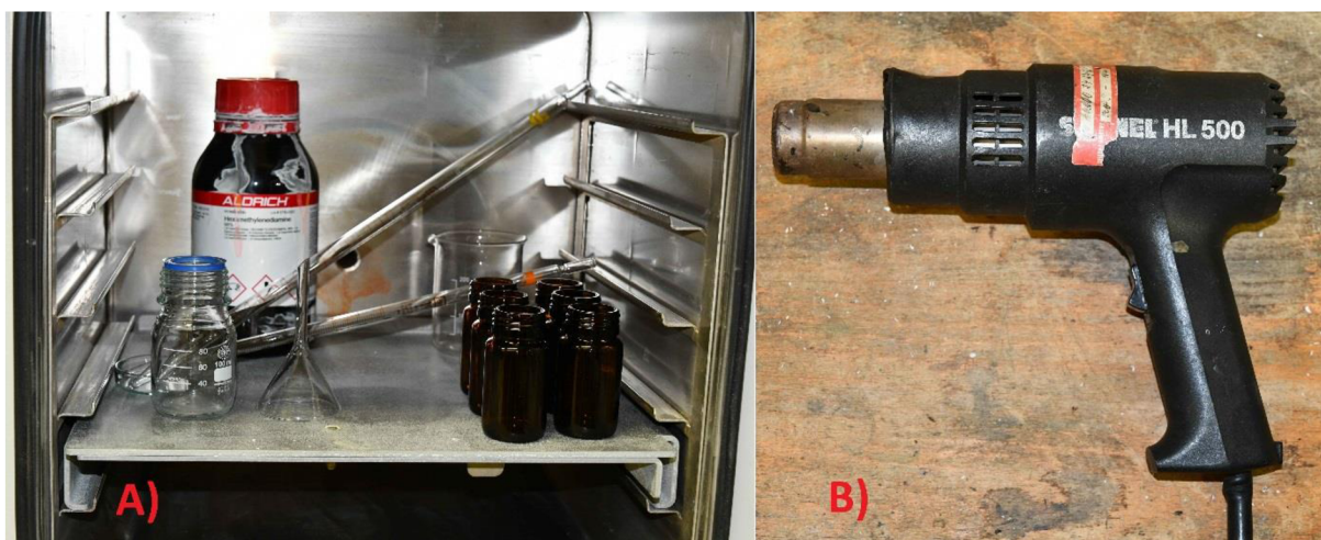
Obrázok 37: A)-Diaminohexán a chemické sklo, uložené na roztopenie a predhriatie, B)-Teplovzdušná pištoľ (HL 500, Steinel)
