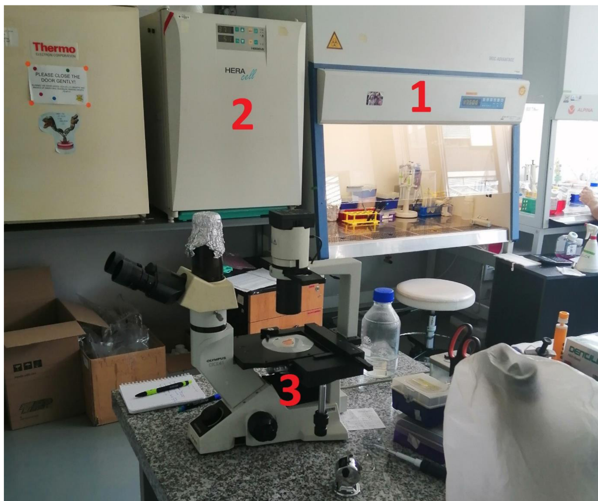
Obrázok 38: Zostava pre kultiváciu, prácu a spočítanie buniek, 1-Flowbox MSC ADVANTAGE, Thermo Scientific), 2-Inkubátor (Hera Cell, Heraeus), 3-Mikroskop (CKX 41, Olympus)
