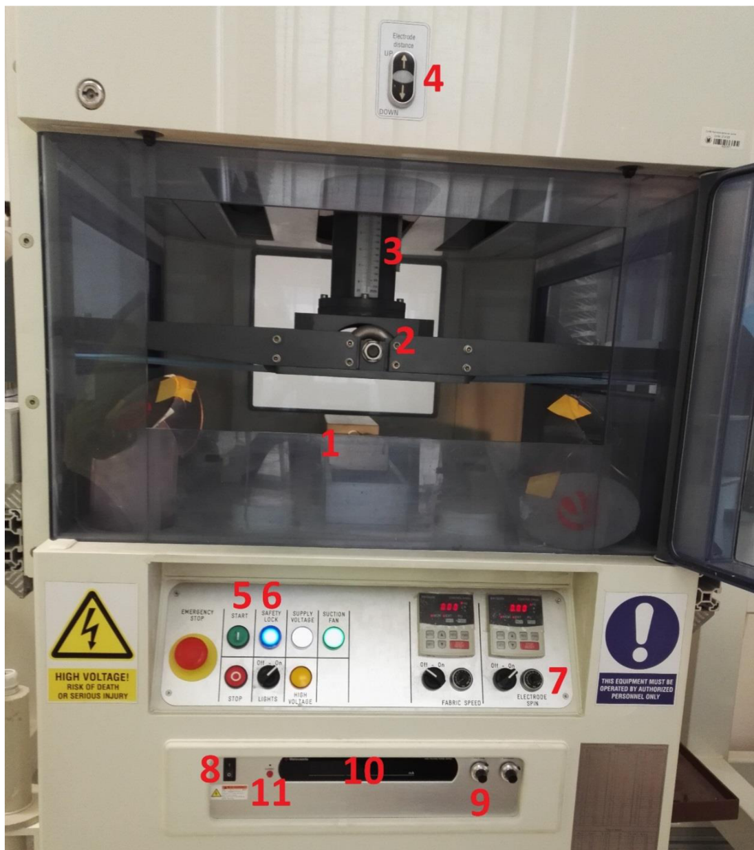
Obrázok 28: 1-Vanička s roztokom a vloženou elektródou, 2-Uzemnená elektróda, 3-výškovo nastaviteľný záves uzemnenej elektródy so vzdialenosťou, 4-Tlačidlo nastavujúce vzdialenosť elektród, 5-štart, 6-safety lock, 7-Nastavenie rýchlosti otáčania elektródy, 8-Zapnutie napájania zdroja, 9-Nastavenie napätia, 10-Displej, 11-Tlačidlo vkladajúce napätie na elektródy
