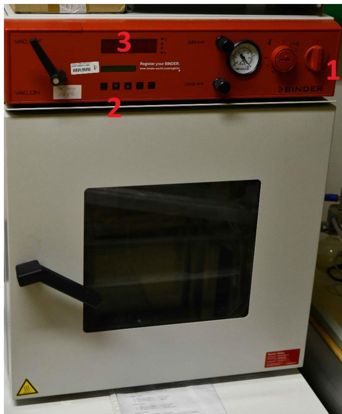
Obrázok 36: Pec (Binder), 1-Štart/stop, 2-Nastavenie, 3-displej
