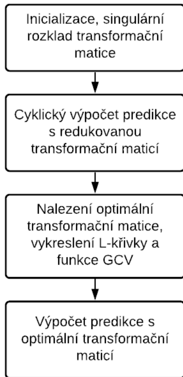
Obrázek 14: Vývojový diagram algoritmu regularizační metody TSVD
