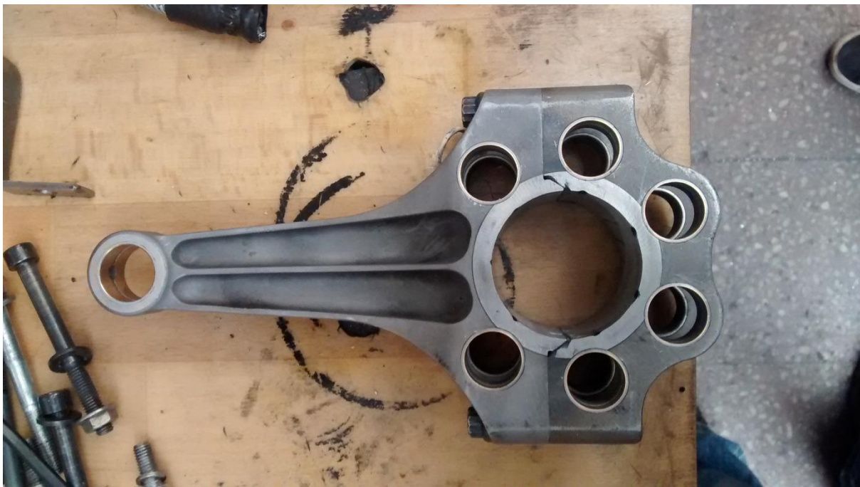
Obr. 16 Hlavní ojnice motoru Verner Scarlett 7H [32]
