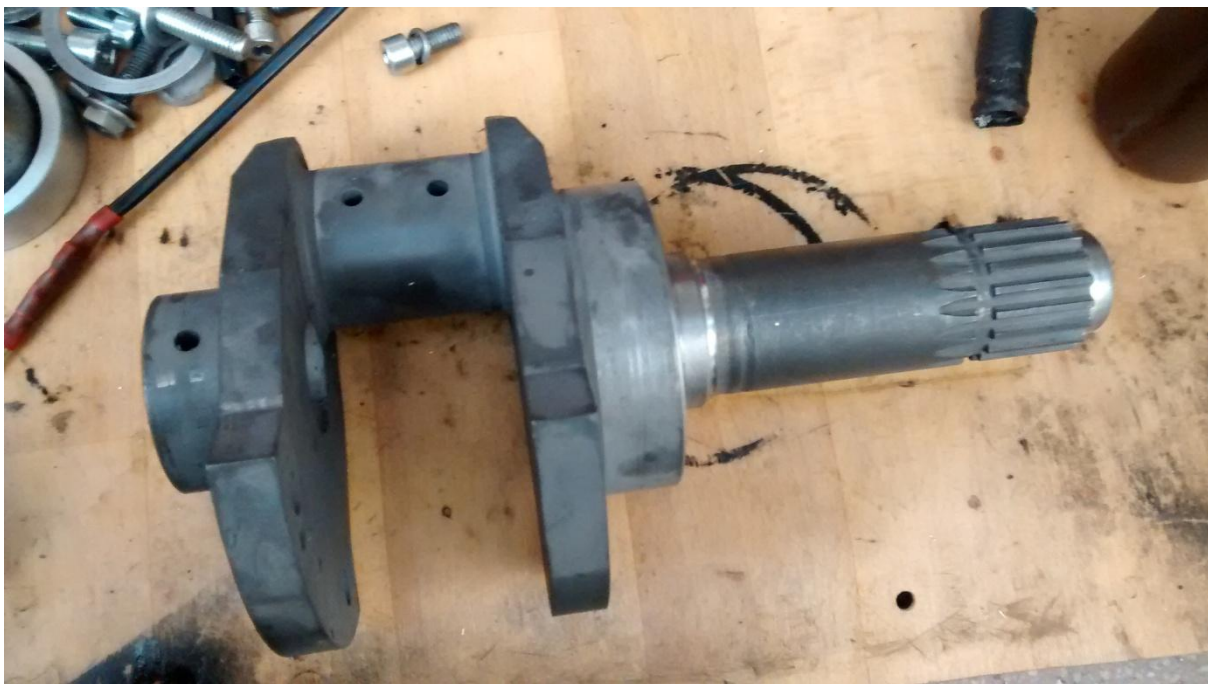
Obr. 19 Klikový hřídel jednohvězdicového motoru Verner Scarlett 7H [34]
