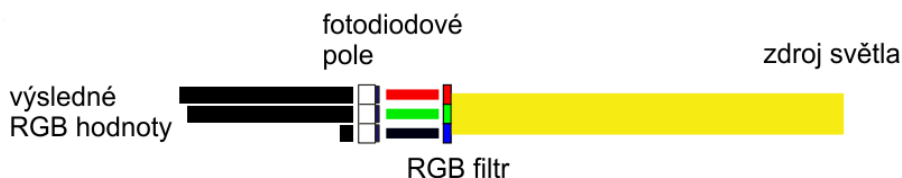
Obr. 2.5: Princip získání dat RGB optickým senzorem. Je měřeno relativní zastoupení tří základních barev ve světle. [9], [10]
