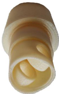
Obr. 3.19 Nerovnosti na povrchu po procesu tisku.
