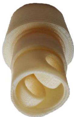
Obr. 3.19 Nerovnosti na povrchu po procesu tisku.
