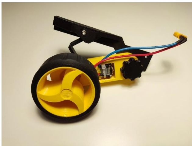
Obr. 3-1: Polovina nápravy demonstrátoru
