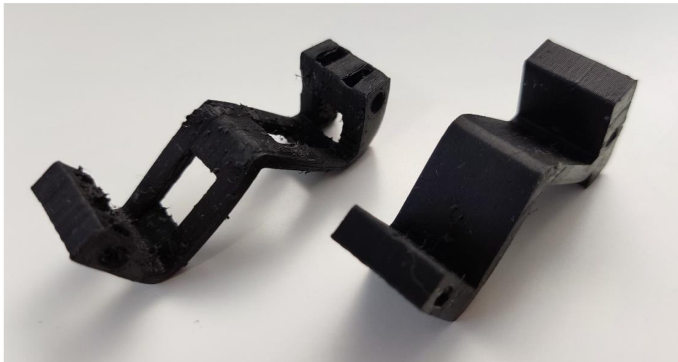
Obr. 3-8: Rozdíl kvality 3D tisku změnou nastavení tiskového profilu
