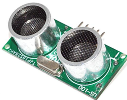
Obr. 4-8: Senzor vzdálenosti US-100 [10]
