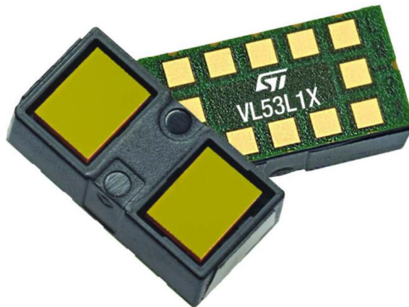
Obr. 4-6: Senzor vzdálenosti VL53L1X [7]
