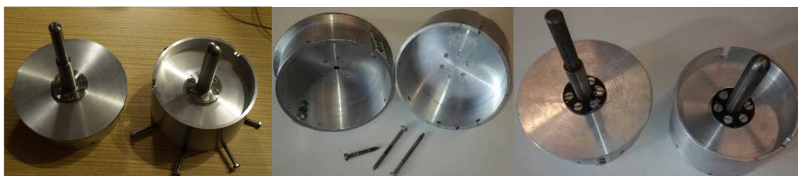
Obr. 16. Upevňovací misky pro upevnění vzorku kadaverózní páteře do stroje BS-II.
