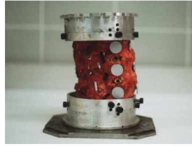
Obr. 2. Aplikace klecí a šroubů pro stabilizaci vzorku.
