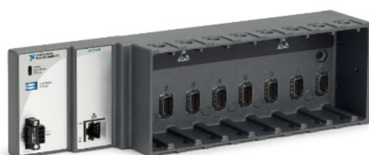
Obr. 9. Šasi systému CompactRIO NI 9148 od společnosti National Instruments [20].
