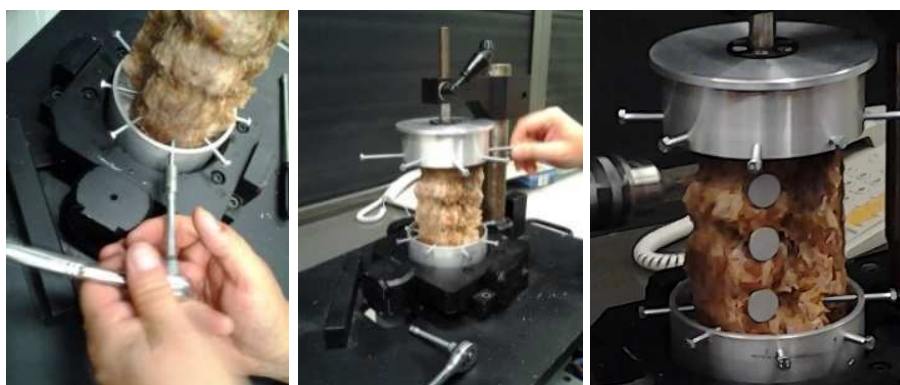
Obr. 26. Montáž měřeného vzorku do cartridge stroje a instalace značek pro snímání polohy.
