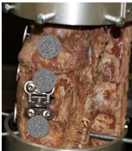
Obr. 64. Vzorek měřené páteře s implantátem LUMIR XLIF CAGE.
