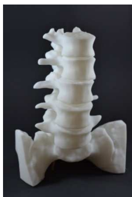
Obr. 68. a.) Model lumbální části páteře vyrobený technikou 3D tisku. b.) Model upravený do podoby cartridge pro měření v zařízení BS-II.
