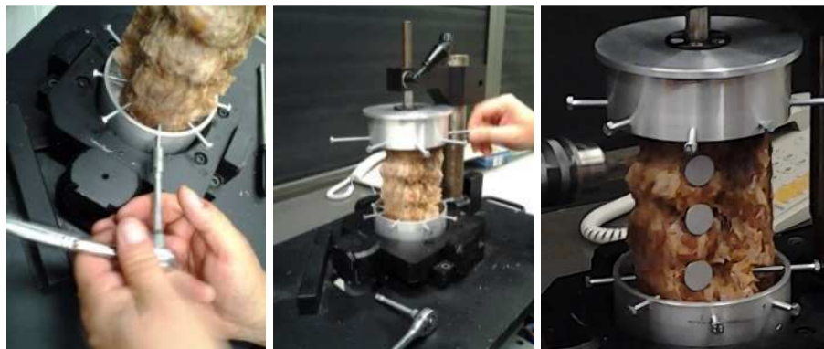
Obr. 61. Montáž měřeného vzorku do cartridge stroje a instalace značek pro snímání polohy.
