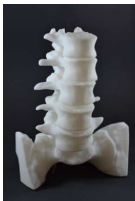
Obr. 33 a) Model lumbální části páteře vyrobený technikou 3D tisku. b) Model upravený do podoby cartridge pro měření v zařízení BS-II.
