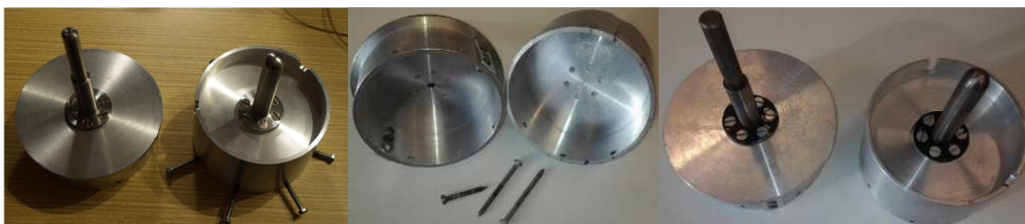
Obr. 2. Upevňovací misky pro upevnění vzorku kadaverózní páteře do stroje BS-II.
