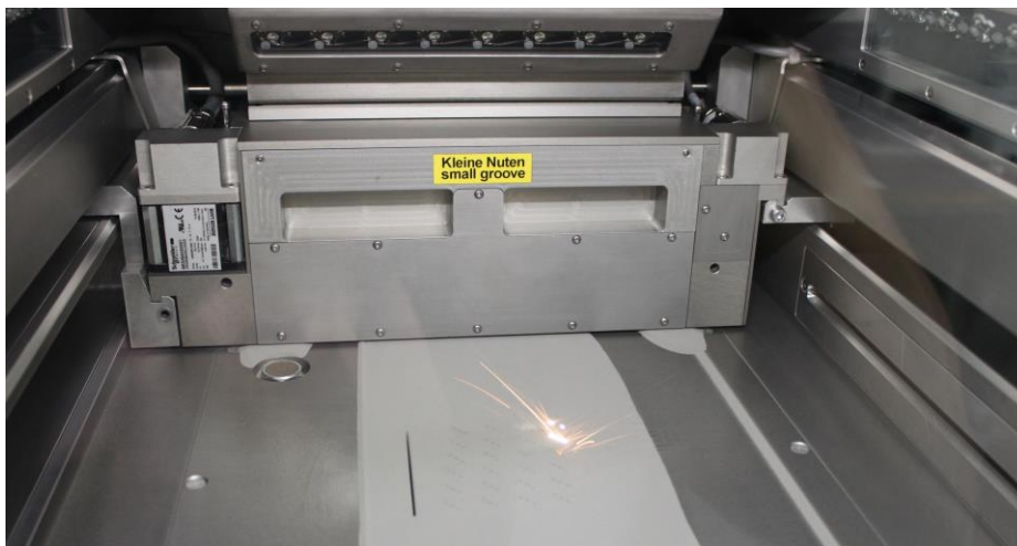
Obrázek 2-12 Recoater tiskárny SLM 280HL během stavby
