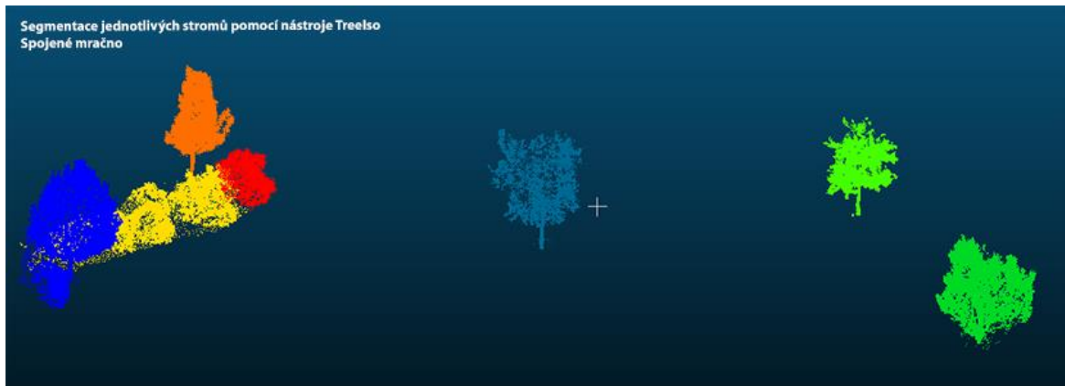
Obrázek 36 - Segmentace jednotlivých stromů nástrojem Treelso
