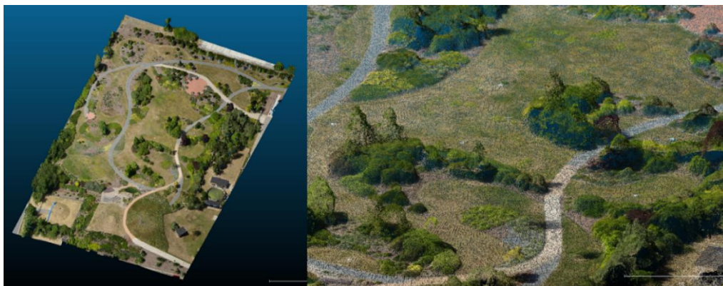
Obrázek 9 - UAV bodové mračno vytvořené algoritmem SfM
