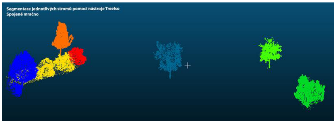
Obrázek 36 - Segmentace jednotlivých stromů nástrojem Treelso
