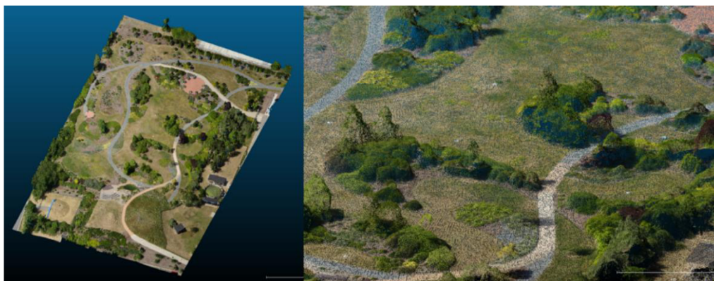
Obrázek 9 - UAV bodové mračno vytvořené algoritmem SfM
