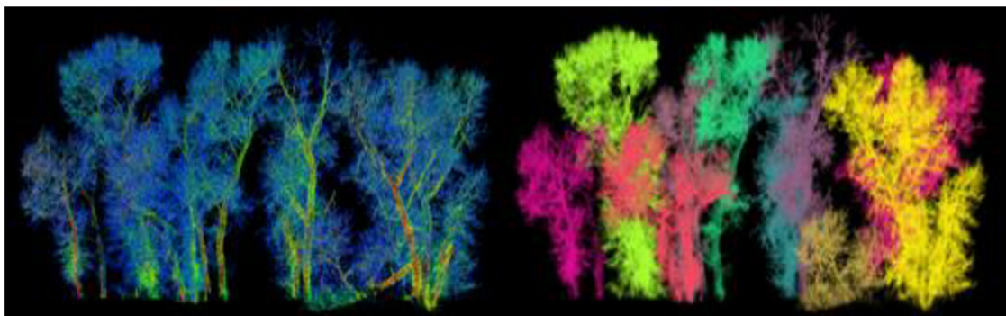
Obrázek 7 - Ukázka segmentace stromů pomocí nástroje TreeIso (Xi et al., 2022)
