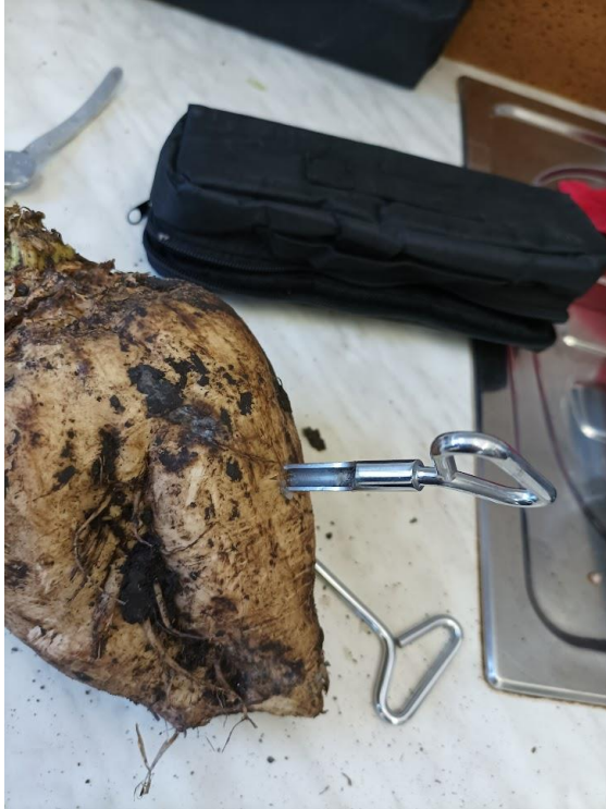
Obrázek 14: Odebírání vzorku ze středu bulvy (foto Ryglová).
