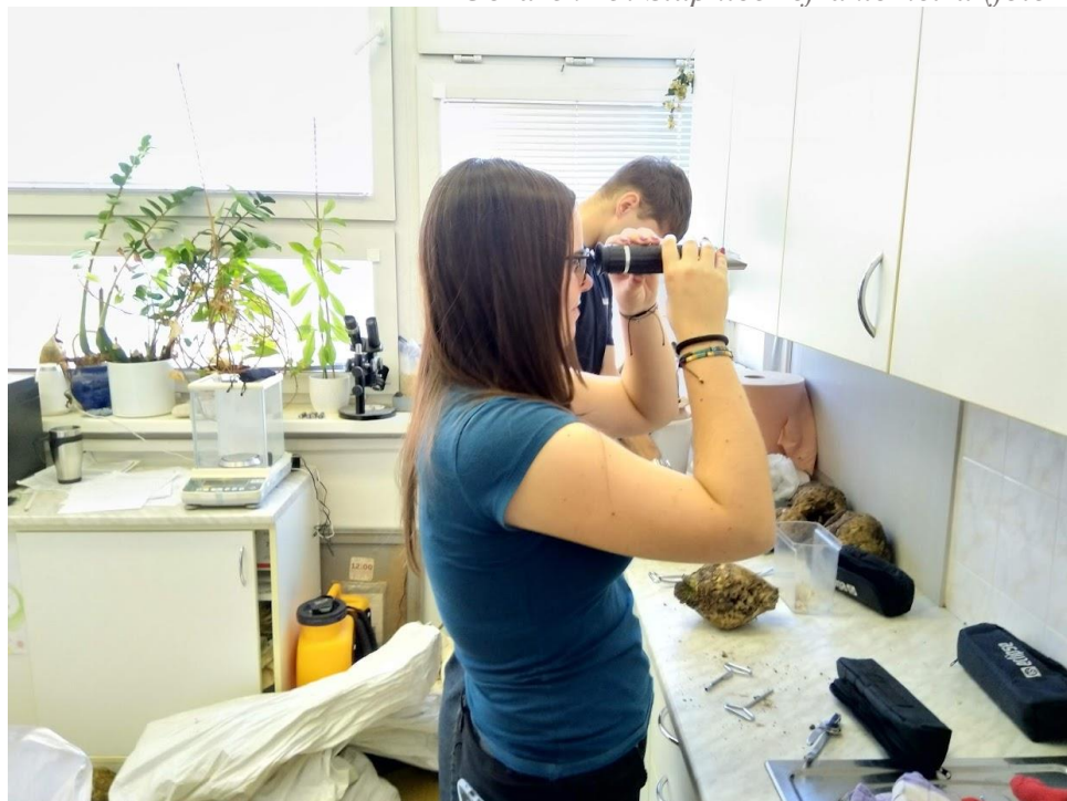
Obrázek 16: Využití refraktometru při vyhodnocení cukernatosti (foto Procházka).
