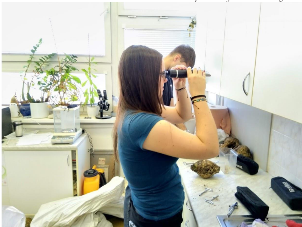
Obrázek 16: Využití refraktometru při vyhodnocení cukernatosti (foto Procházková).
