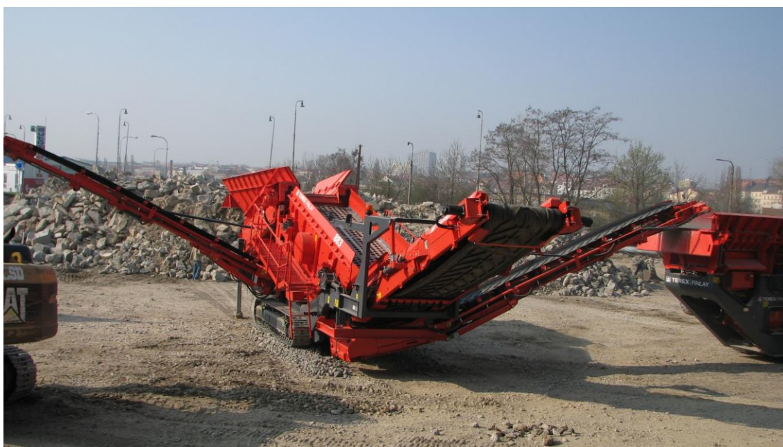
Obrázek 7 Mobilní třídič FINALY 883 Reclaimer [1]
