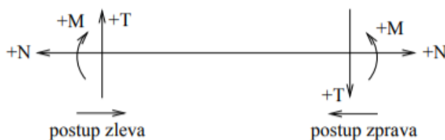
Obrázek 7: Znaménková úmluva pro vnitřní silové účinky (Plánička, online)
