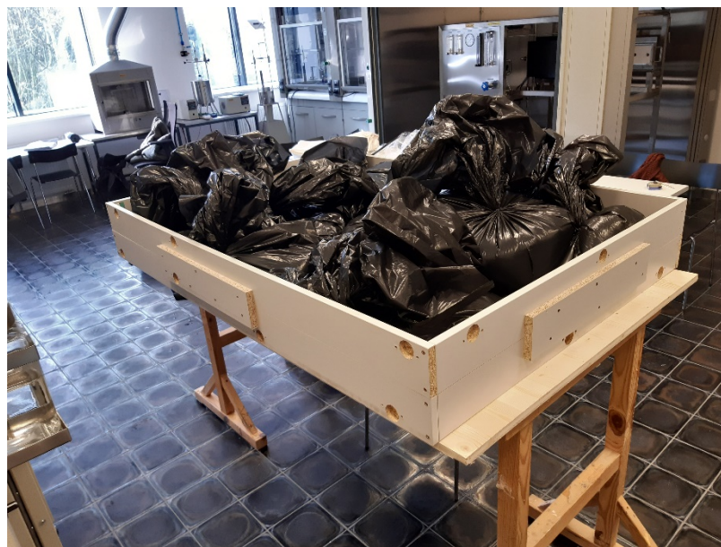
Obrázek 20: Experimentální zatěžování desky
