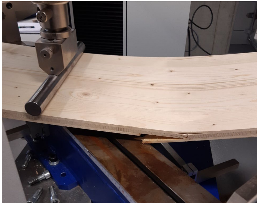
Obrázek 24: Porušení I. desky na trhacím stroji
