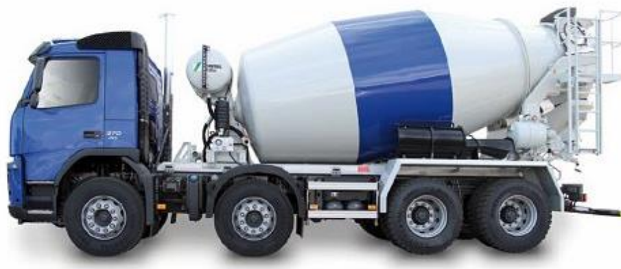
Obrázek 8: Autodomíchávač STETTER C3 BASIC LINE [24]
