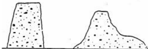
Obrázek 34.: Tvary sednutí kužele (správné sednutí a usmýknuté sednutí) [61]
