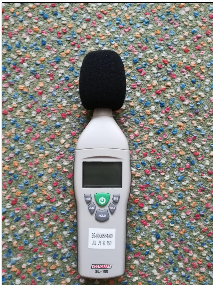
Obrázek 31 - Přístroj pro měření hluku Voltcraft sl-100
