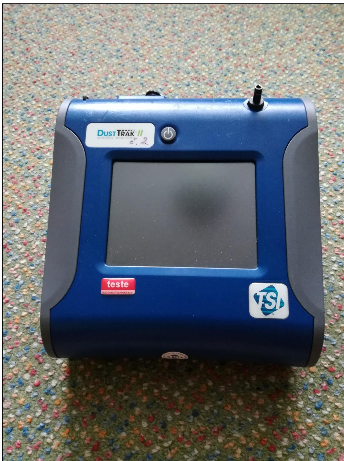
Obrázek 30 - Přístroj pro měření prachových částic DustTRak 8530
