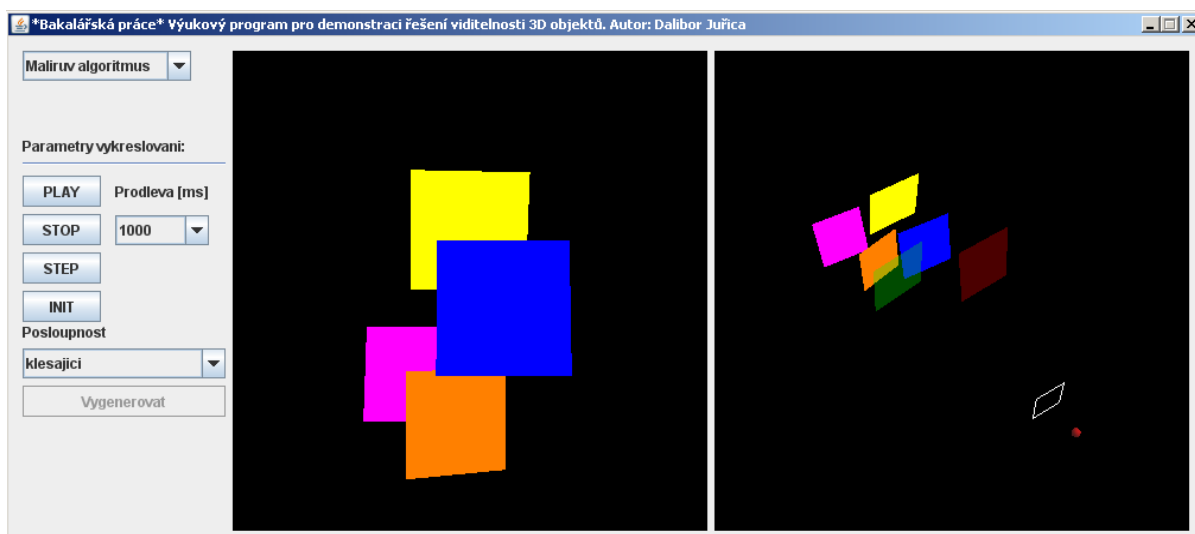
obr 4.5: Vykreslení scény Malířovým algoritmem ve správném seřazení.
