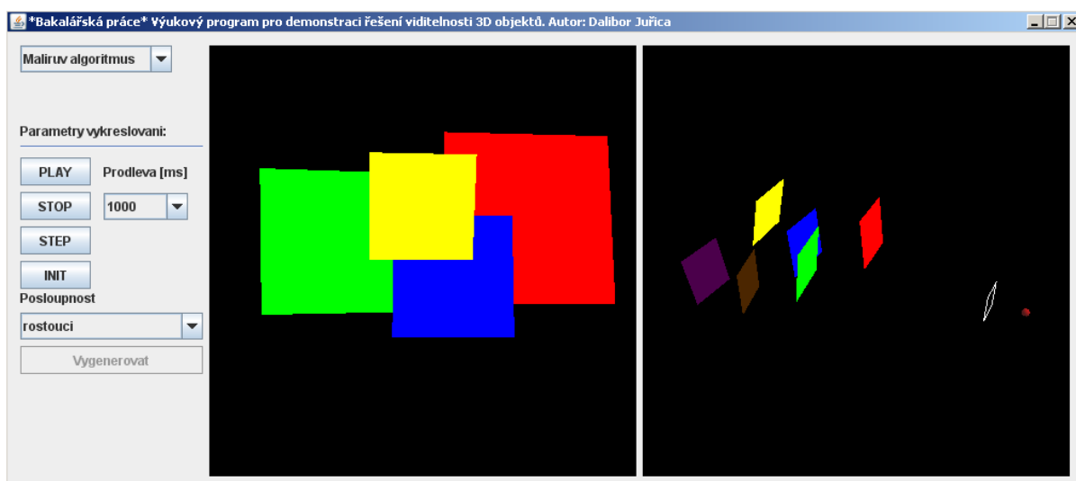
obr 4.4: Vykreslení scény Malířovým algoritmem v nesprávném seřazení.
