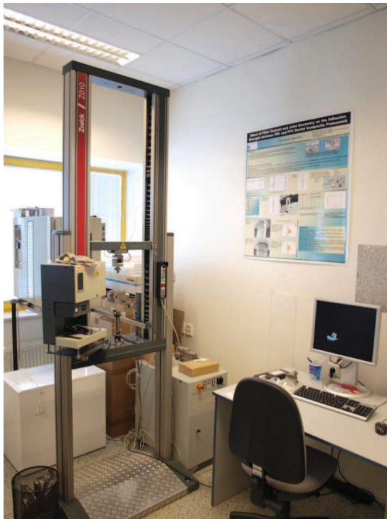
Obrázek 20: Mechanické testovací zařízení Zwick 010
