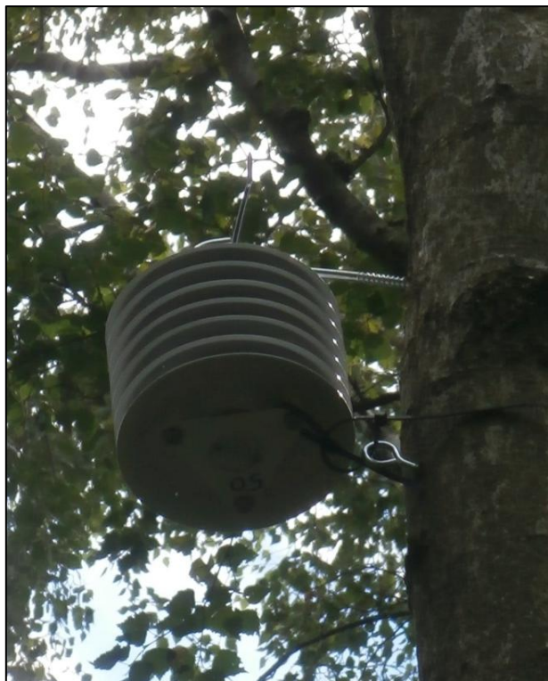
Obr. 6: Zavěšený datalogger Minikin THI Minikin s radičním krytem (zdroj autor)
