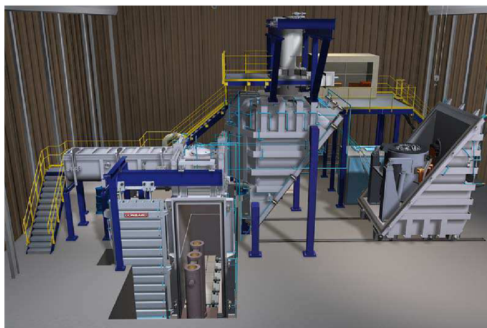
Obr. 1.4 elektrická indukční pec vakuová [4]
