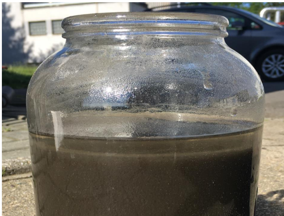
Obrázek 28 - Sedimentace aktivovaného kalu [zdroj: vlastní pořizní]
