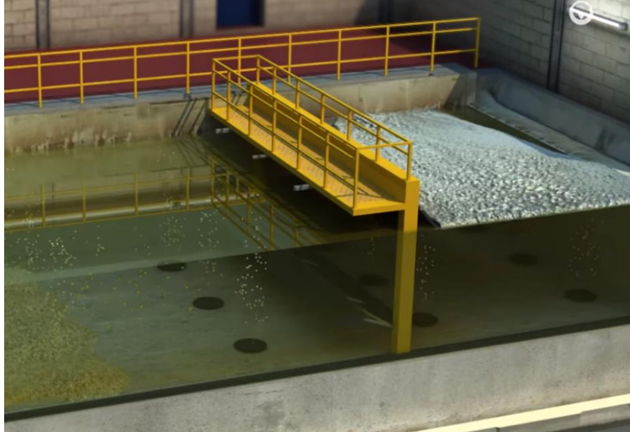
Obrázek 16 - Odstraňování tuků a plovoucích nečistot v lapáku písku [53]
