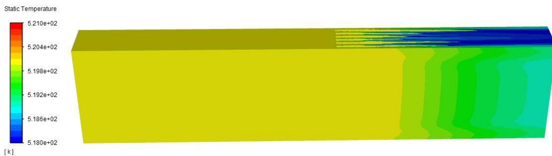
Obr 5.16 Průběh teplot na stěnách modelu s trubkami při simulaci s vypnutými rovnicemi sálání
