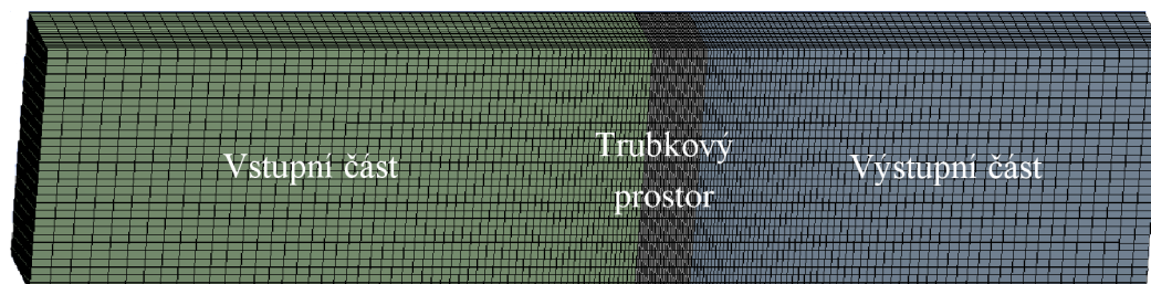
Obr 5.9 Ukázka kanálu pro výpočet sálání bez modelování trubek výměníku
