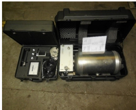
Obr. 2.2 - Měřící zařízení Wabco CTU pro měření brzdového náběhu přípojného vozidla
