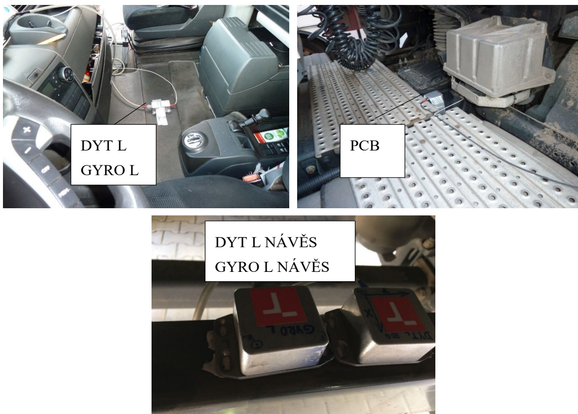
Obr. 2.13 - Zobrazení snímačů a jejich umístění na jízdní soupravě
