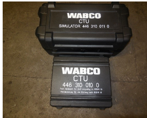
Obr. 2.1 - Měřící zařízení Wabco CTU pro měření brzdového náběhu přípojného vozidla
