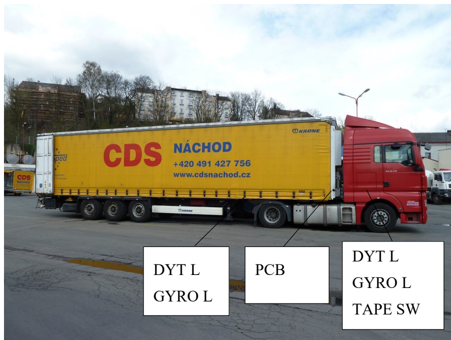
Obr. 2.12 - Umístění snímačů na jízdní soupravě
